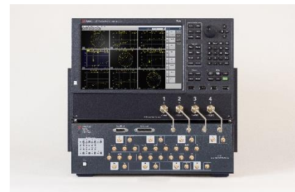
配有 E5092A 可配置多端口测量仪的 E5080B ENA
